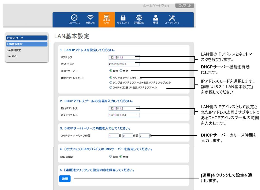
図 6-2 に示すように、「LAN」タブを選択し、左のナビゲーションツリーの「IP ネットワーク」> 「LAN 詳細設定」を選択します。
