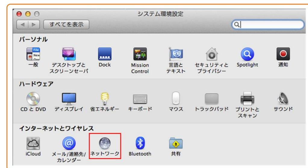
2. 「インターネットとワイヤレス」エリアの「ネットワーク」を選択します。図 5-21 に示すような「ネットワーク」ダイアログボックスが表示されます。
