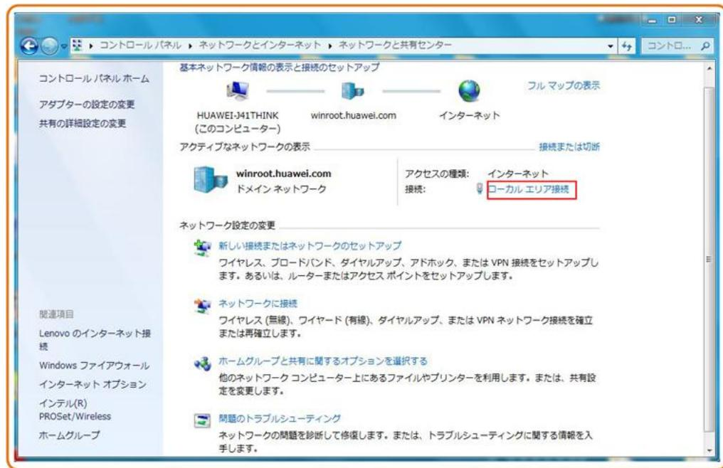
3. 「アクティブなネットワークの表示」エリアの「ローカル エリア接続」をクリックします。図 5-11 に示すような「ローカル エリア接続の状態」ダイアログボックスが表示されます。
