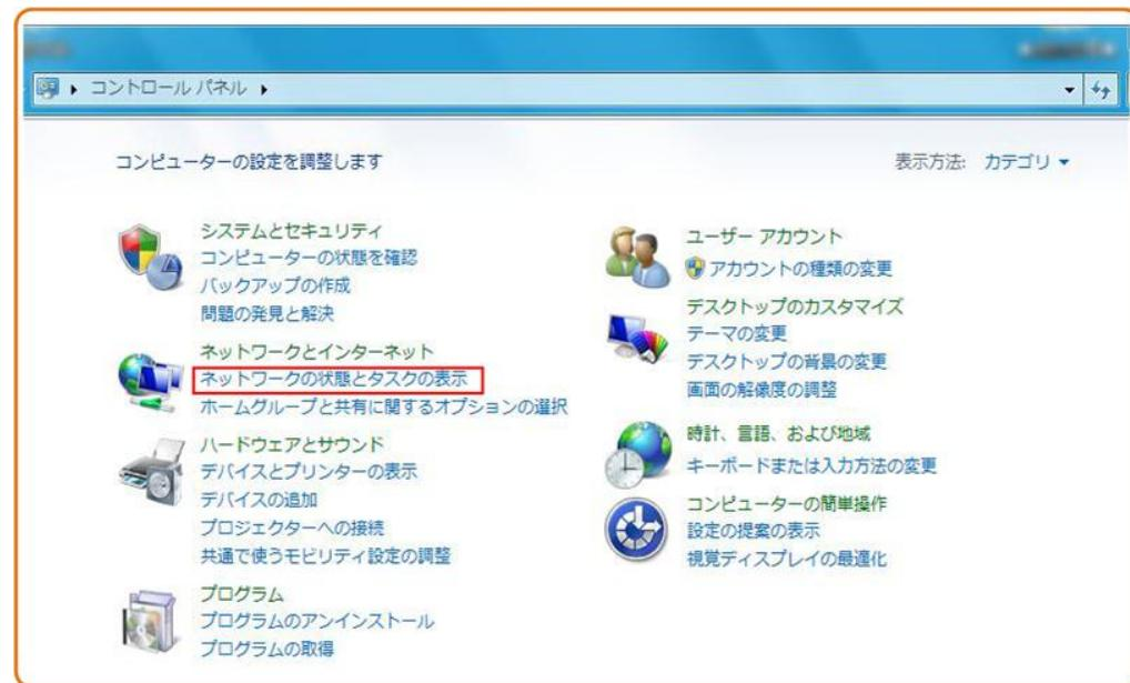
2. 「ネットワークとインターネット」の下の「ネットワークの状態とタスクの表示」をクリックします。図 5-10 に示すような「ネットワークと共有センター」ウィンドウが表示されます。
