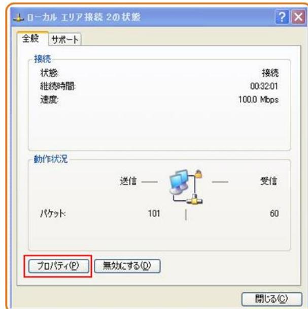
4. 「全般」タブを選択して、「プロパティ」をクリックします。図 5-17 のような「ローカル エリア接続のプロパティ」ダイアログボックスが表示されます。
