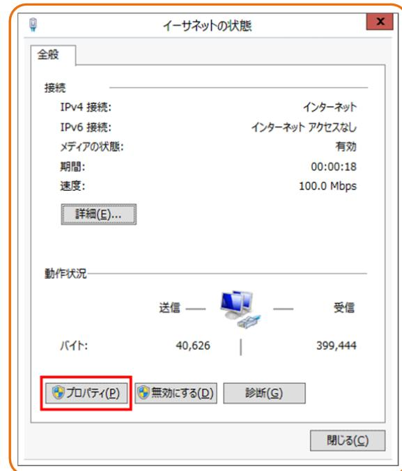
7. 「プロパティ」をクリックすると、図 5-7 のような「イーサネットのプロパティ」ダイアログボックスが表示されます。
